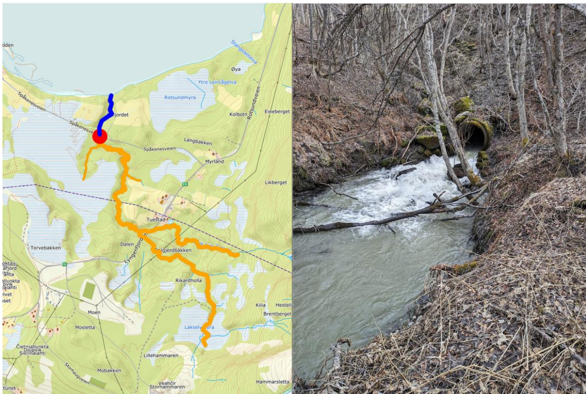
Figur 9: Kulverten under Spåkenesveien hinder sjørørret og sjørøye fra å nå gyteområdene i elva. Resultater er at den lokale bestanden av sjørørret og sjørøye er utryddet. Spåkenesøra naturreservat har følgelig også mistet en brikke i økosystemet.
